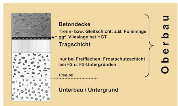
Bild 2: Aufbau eines Betonbodens
