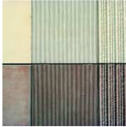
Bild 18: Durchgefärbter Beton, 2 % Eisenoxidgelb, weißer und grauer Zement
