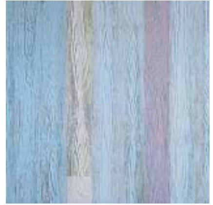
Bild 19: Betonoberfläche mit transparenter Farblasur, Mineralfarbe
